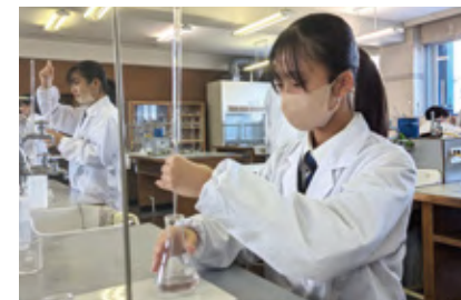
酢酸の定量実験 食酢に含まれる酢酸を測定。分析技術の基本
