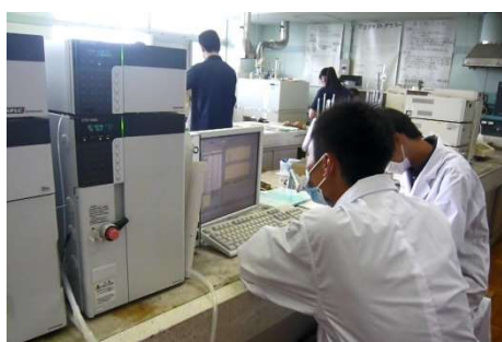
(高速液体クロマトグラフィーHPLCによる緑茶のカフェイン分析の様子)
