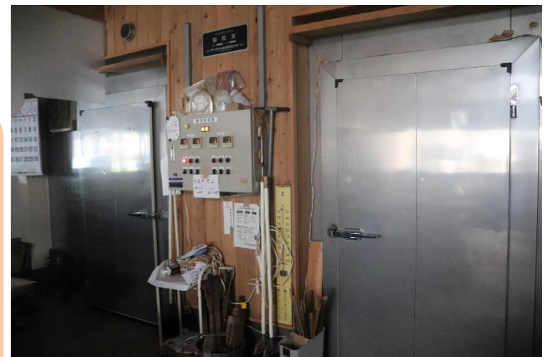
糀屋商店の「製糀室」は、ステンレス製のものを使用している。この中で糀菌が育てられる。他の菌が混ざらないよう、衛生管理を徹底して行っているそう。
