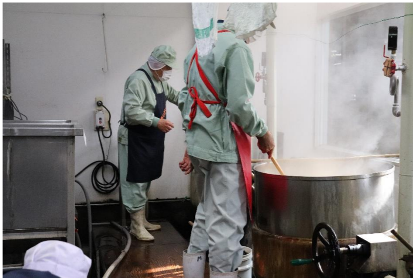
サトウキビを圧搾して抽出した煮汁をよく濾し、じっくりと火にかけて灰汁を取り除いていく。大きな鍋をかき回し、何度も何度も灰汁を取る作業は体力が要る。
