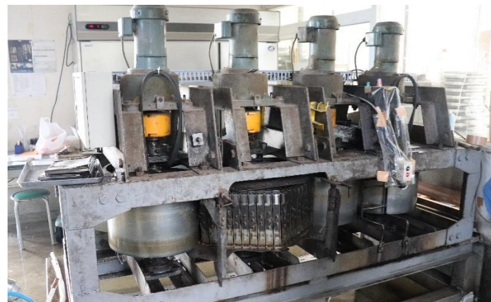
サトウキビを圧搾する機械。回るローラーにサトウキビを差し込み、両端からサトウキビを絞っていく。しぼり汁はチューブを通して運ばれていく。
