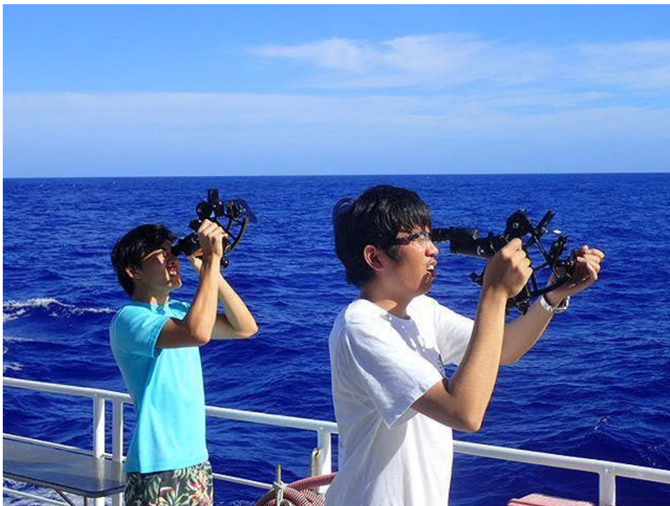
こちらは専攻科の「天測」。航海士の基本、太陽高度測定です。手にしているのは「六分儀（ろくぶんぎ）」という航海計器です。コロンブスもこうやって太陽高度を測り、自分の位置を割り出したのかもしれない。
