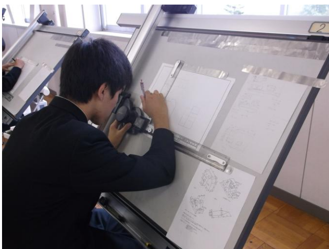
ドラフターを使った手書き製図の様子 (コンピュータの製図もあります)
