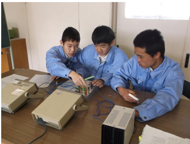
コンデンサの充電と放電の特性を調べます。
