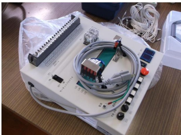
PLC（プログラマブル コントローラ） ベルトコンベアを動かすプログラム作成
