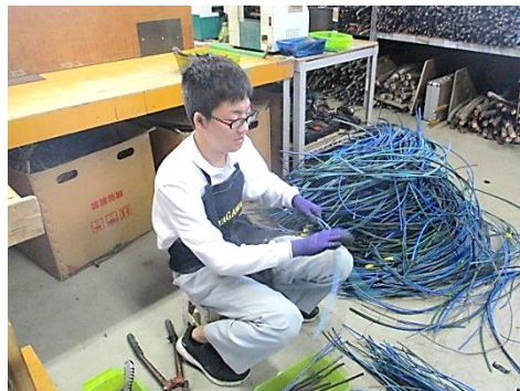
一本一本力を込めての銅線剥き作業
